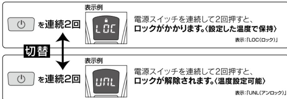
※ロック状態でも電源スイッチを長押しすると、電源がOFFになります。
